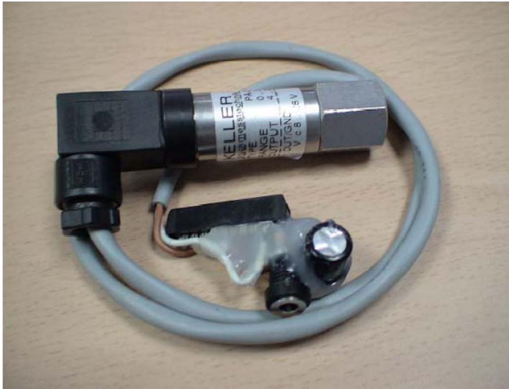
Figura 2: Montaje del sensor
